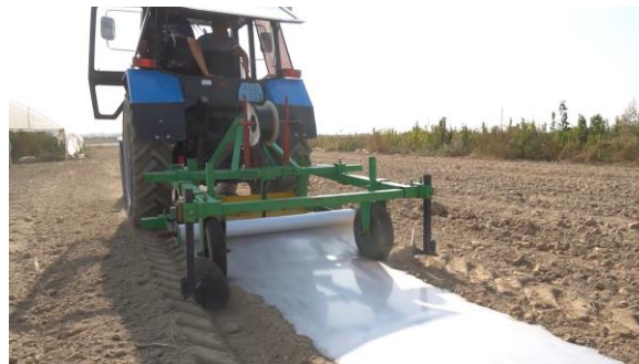
Рис. 2 - Навесной агрегат для формирования гребней, укладки гибкой ленты и растила мульчирующей пленки, КА ФГ-1,2
