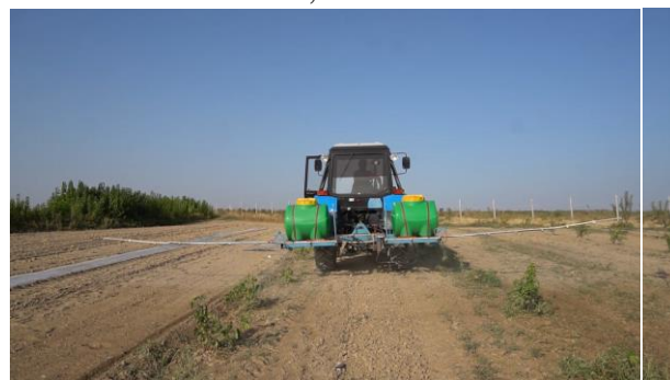
Рис. 2 - Навесной агрегат для формирования гребней, укладки гибкой ленты и растила мульчирующей пленки, КА ФГ-1,2
